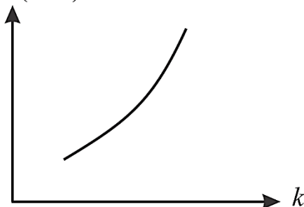
Рис. 3. Схематическое изображение эффекта понижения критической величины поврежденных связей при радиационном воздействии на ФГР для её дестабилизации т.е. и деградации приборных структур, содержащих такие ФГР.
